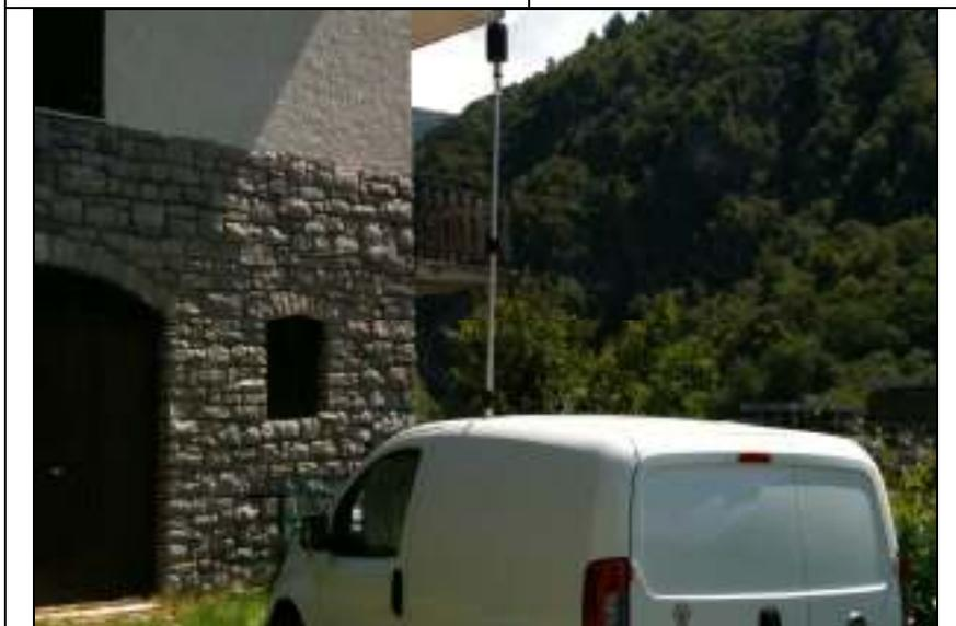
Il rilievo è stato eseguito posizionando la strumentazione a ridosso del confine dello stabilimento produttivo, in prossimità della prima abitazione che si pone al termine di via rocca, dove quest'ultima diventa una stretta mulattiera non carrabile.
