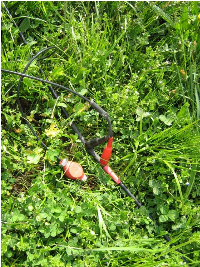
PIANO SISMICO DI ALBINO: INDAGINI REMI - ACCOPPIAMENTO GEOFONI TERRENO
