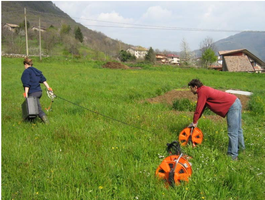
PIANO SISMICO DI ALBINO: INDAGINI REMI - STESURA DEI CAVI CON I GEOFONI
