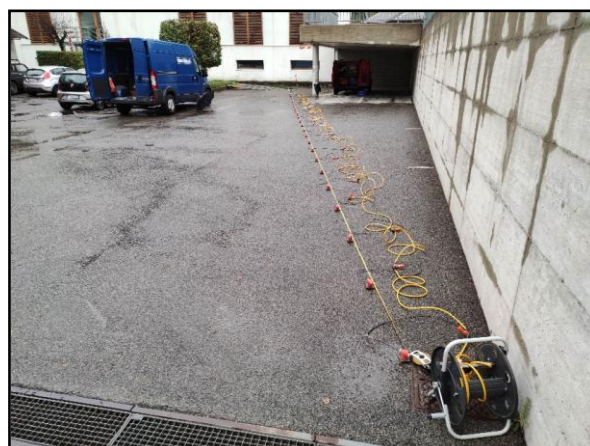
Indagini geognostiche: prova penetrometrica e prospezione geofisica MASW.
