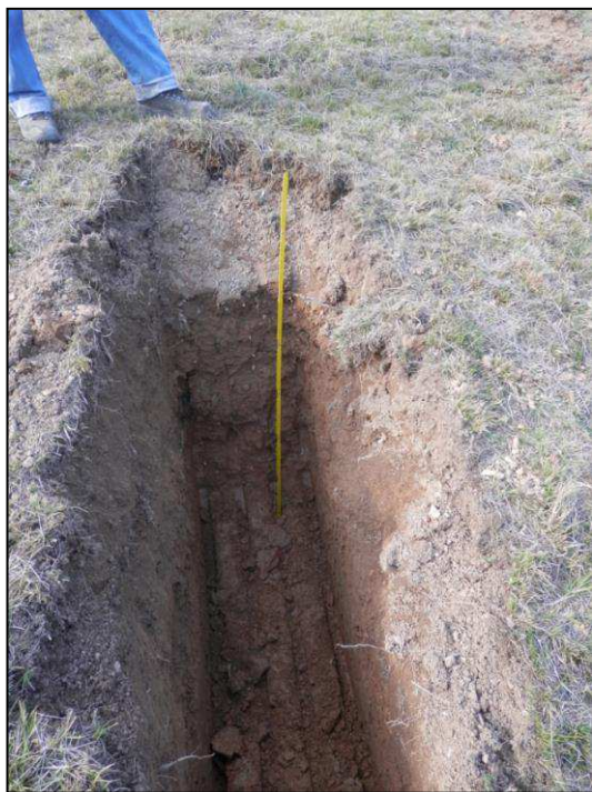
Foto 7: nel secondo settore è presente una coltre eluvio-colluviale di natura limoso sabbiosa (circa 0,40 m di spessore) che ricopre un deposito di versante limoso argilloso di colore bruno.
