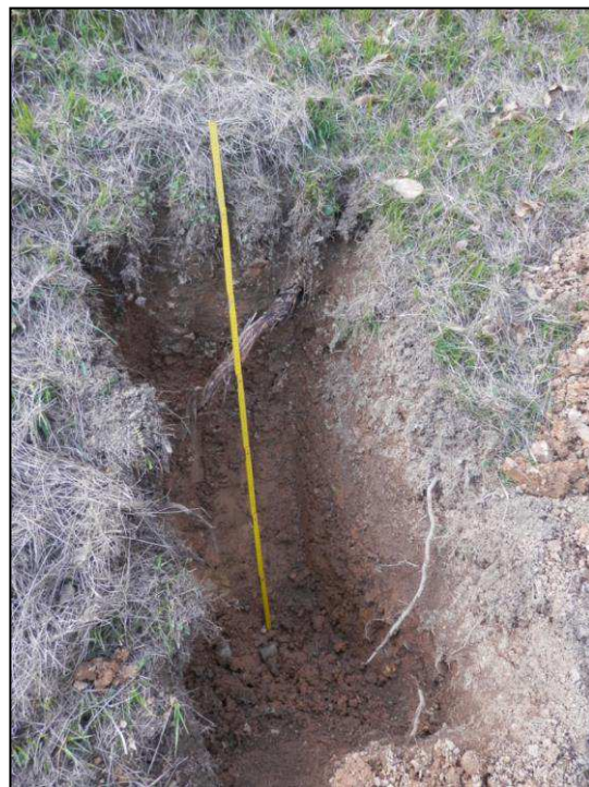
Foto 6: nel primo settore è presente una sottile coltre eluvio-colluviale di natura limoso sabbiosa (circa 0,30 m di spessore) che ricopre un deposito di versante limoso argilloso di colore bruno.
