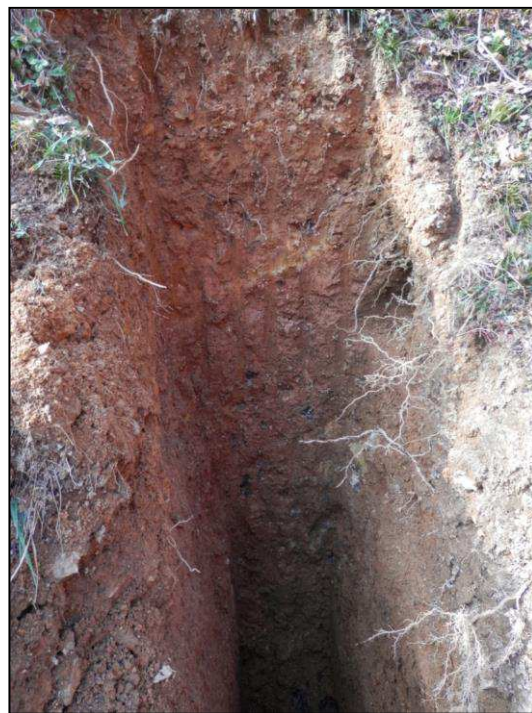
Foto 8: nel ultimo settore, è presente una sottile coltre eluvio-colluviale di natura limoso sabbiosa (circa 0,20 m di spessore) che ricopre un deposito di versante limoso argilloso di colore rossastro.
