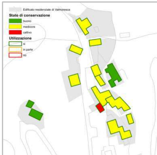
Figura 3-101: Stato di conservazione del costruito di Valmoresca
