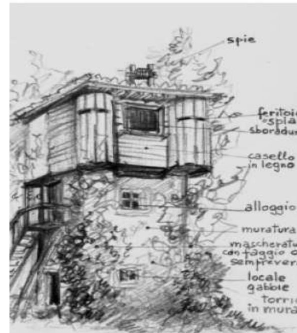
Figura 3-124: Struttura del casello (CALEGARI – RADICI – MORA, 1996, p.40)
