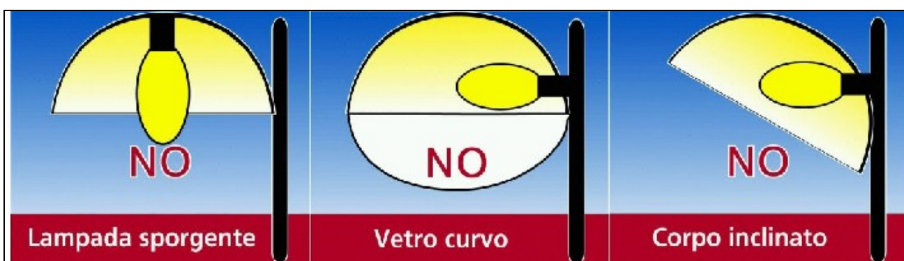
Figura 5.1 – Tipologie di apparecchi non ammessi
