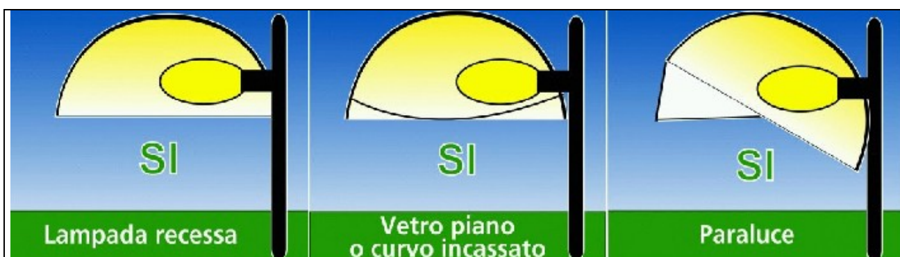
Figura 5.2 – Tipologie di apparecchi conformi alla legge n.17/2000
