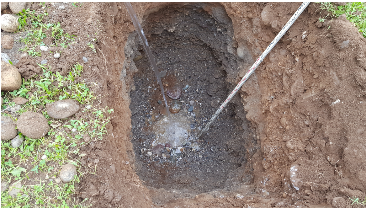
Foto n. 11: immissione dell'acqua necessaria alla conseguente prova di permeabilità a carico variabile, eseguita nel pozzetto A1
