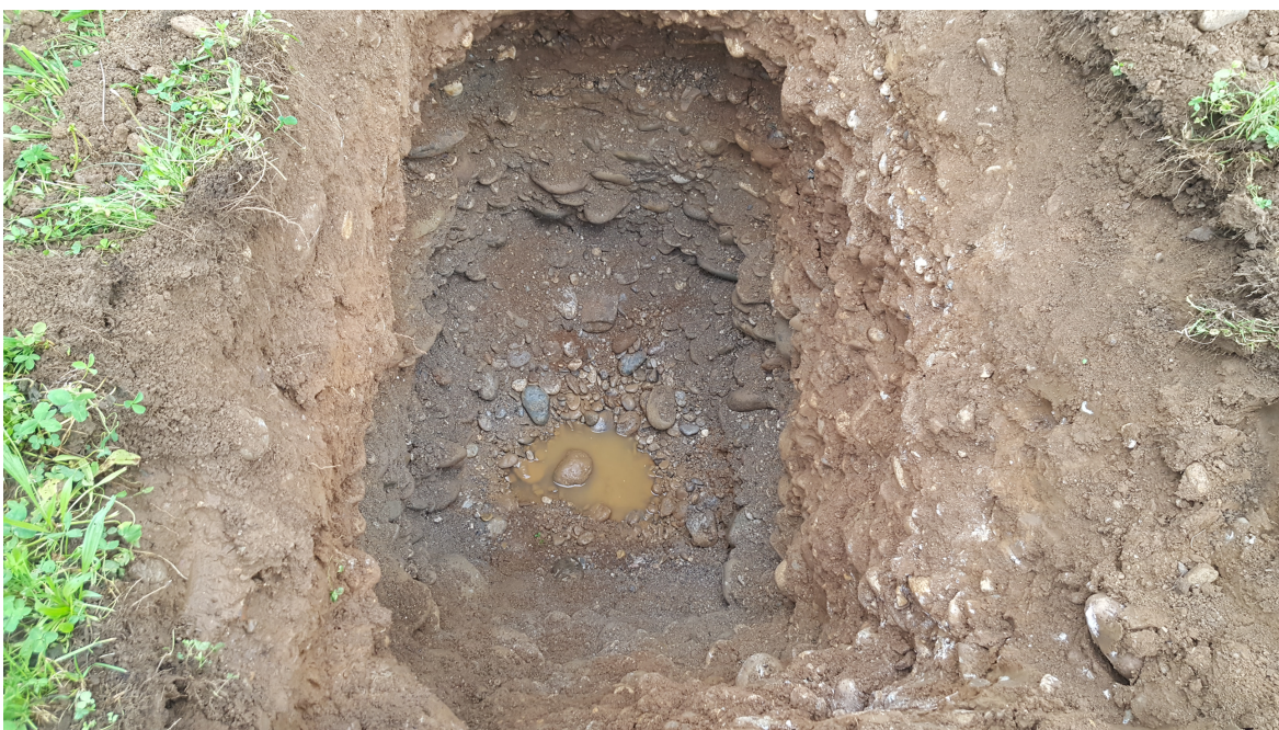
Foto n. 12: fase terminale della prova di permeabilità a carico variabile, eseguita nel pozzetto A2
