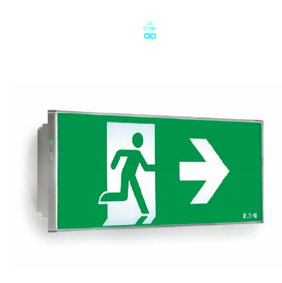
PARTICOLARE CORPO ILLUMINANTE TIPO EATON NEXITECH LED 11W 1,5h AT - 150lm - IP65 CON PITTOGRAMMA
