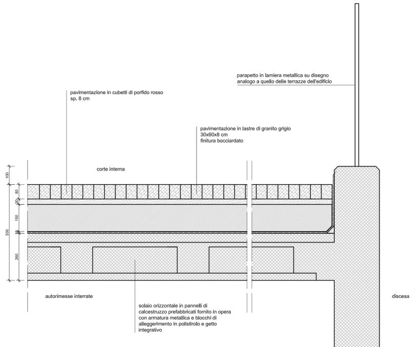
DETTAGLIO 02 Particolare pavimentazione piazza / griglia di areazione box
