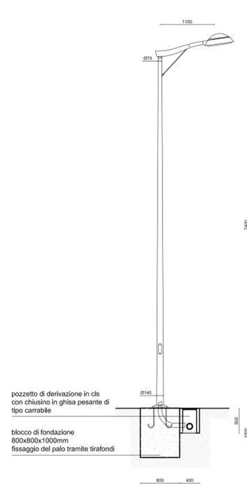
pozzetto di derivazione in cls con chiusino in ghisa pesante di tipo carrabile
