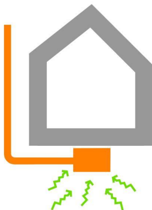
Figura 13: depressione del sottosuolo tramite pozzetto.
