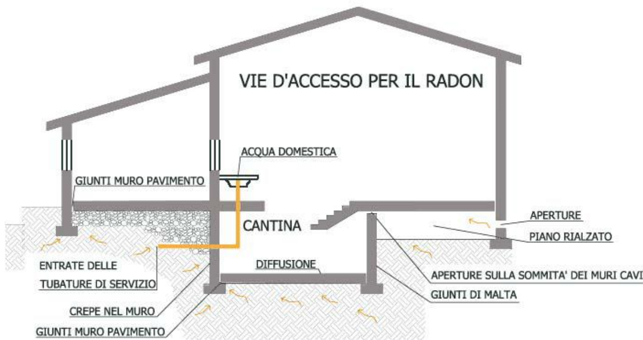
Figura 5: vie d'accesso per il radon
