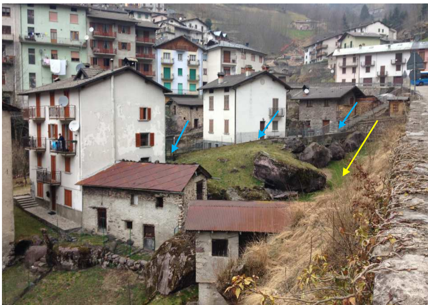
Foto 117. Ripresa della località Fusinetta da monte. Si noti l'avvallamento (freccia gialla) a destra della foto che potrebbe essere ripercorso dalle correnti in deflusso in questo caso caratterizzate da pericolosità bassa in quanto in posizione marginale rispetto alla direzione di tracimazione delle correnti e protetta da ostacoli antropici (individuati dalle frecce)
