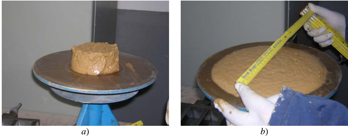
Figura 2.7 - Valutazione della lavorabilità di una miscela mediante prova con tavola scossa (a) e misura dello spandimento (b).
