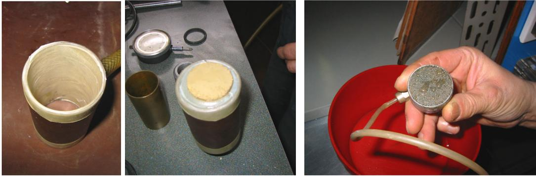
Fig. 34: preparazione dei provini; spalmatura del grasso di silicone e posizionamento del provino nella membrana
