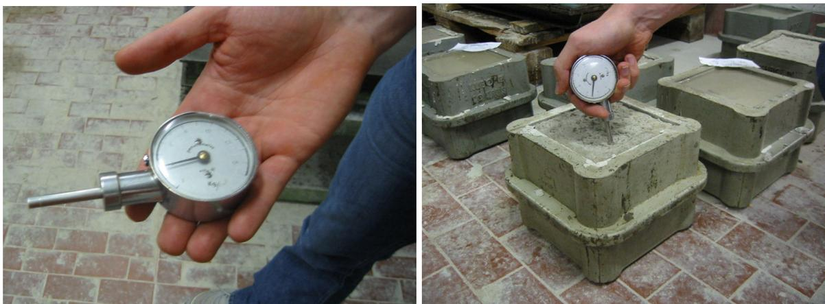
Fig. 11: Il pocket penetrometer e relativa prova su cubo
