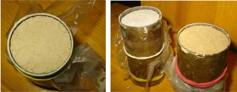
**Fig. 9: Ritiro e formazione di microfessure per provini secchi**
