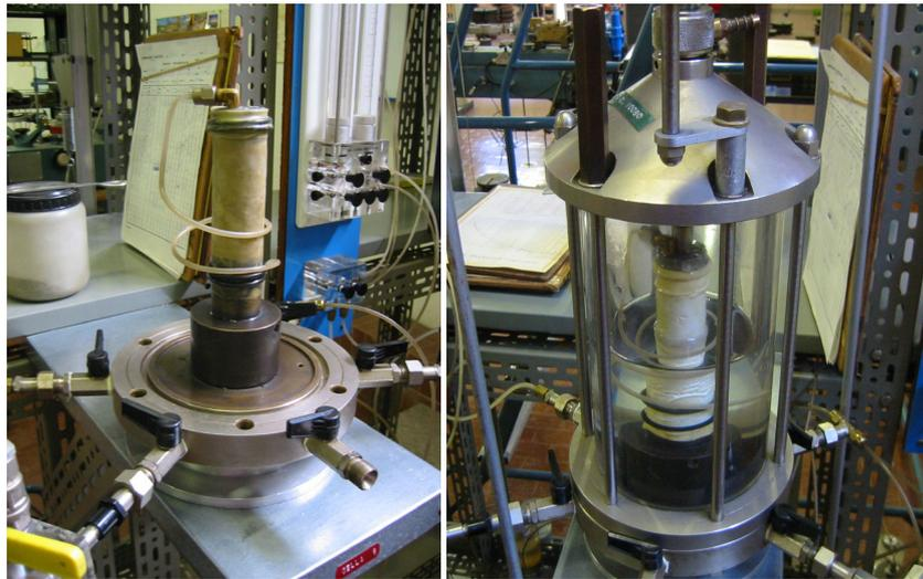
Fig. 35: Sistemazione del provino prima dell'esecuzione della prova.
