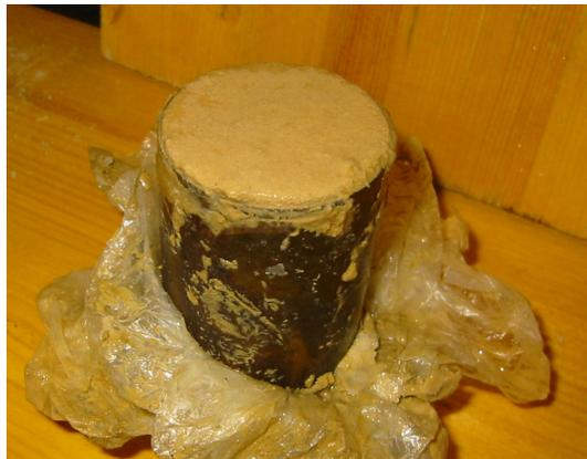
**Fig. 10: – Rigonfiamento per provini umidi**
