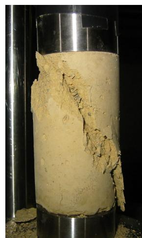
Fig. 27:– Tipica curva sforzi deformazioni-assiale e immagine provino a fine prova Miscela 6 a 40 giorni.
