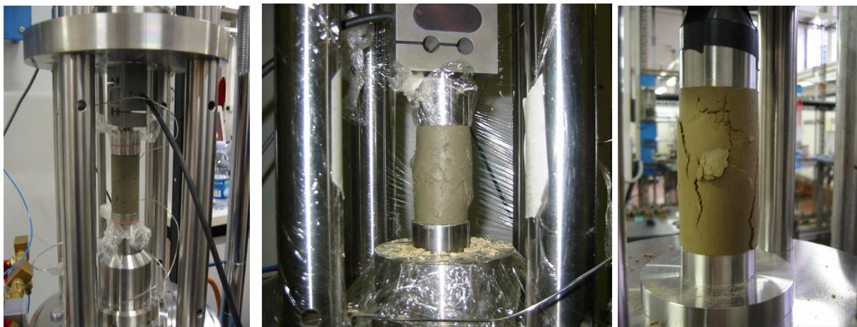
Fig. 18:– Apparecchiatura sperimentale per prove monoassiali
