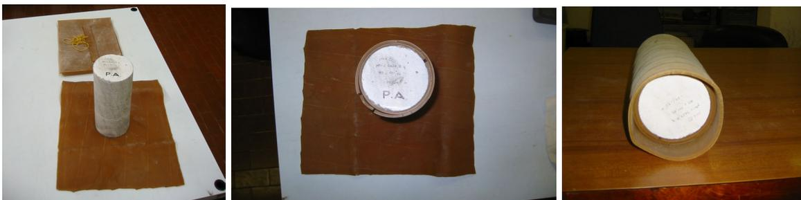
Fig. 41: a) Provino di gesso di  $d=83\text{mm}$  ; b) Provino con gomma di caucciù c) provino avvolto nella membrana
