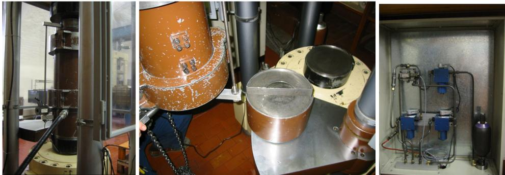
Fig. 43: a) Accessorio posizionamento cella di carico; b) Attacchi oleodinamici; c) Servovalvola, filtri, accumulatore
