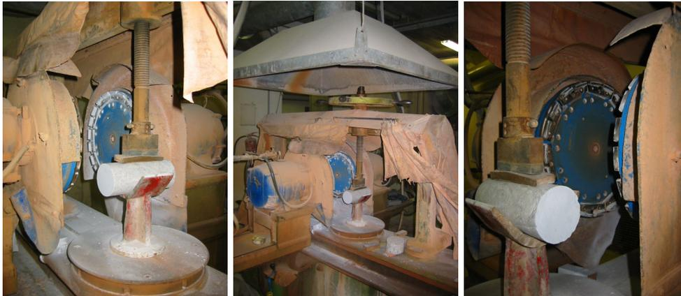
Fig. 40: Macchina per la rettifica delle facce dei provini
