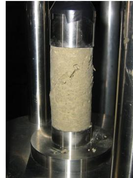
**Foto A2 – Mono 171: rovino alla fine della prova**
