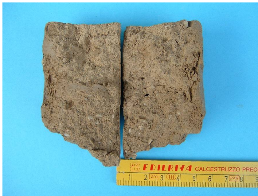
Figura 5.2 – Carota prelevata dalla miscela M91-11 gettata e mantenuta in acqua per 3 mesi.
