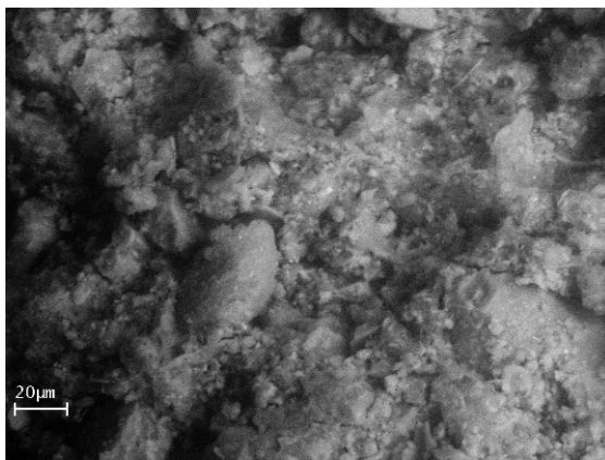
Figura 5.25 – Micrografia ESEM della superficie di frattura del campione M105-2_VI, osservato in condizioni umide.
