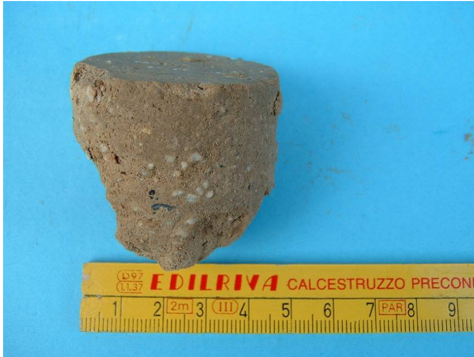
Figura 5.9 – Particolare della carota M96-8, in cui si nota la presenza di aggregati calcarei.
