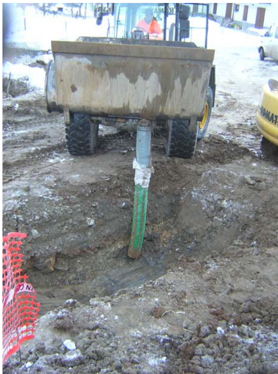
Figura 8.6 - Prova di riempimento di una trincea per verificare la mobilità della miscela.
