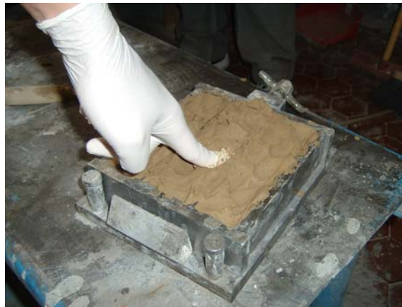
Figura 4.1 - Confezionamento di provini prismatici con la miscela M85-A.
