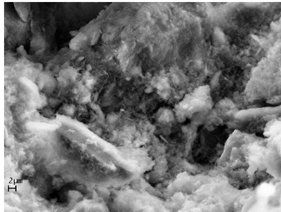
Figura 5.31 – Micrografia ESEM della superficie di frattura del campione M105-2_VI, osservata in condizioni umide
