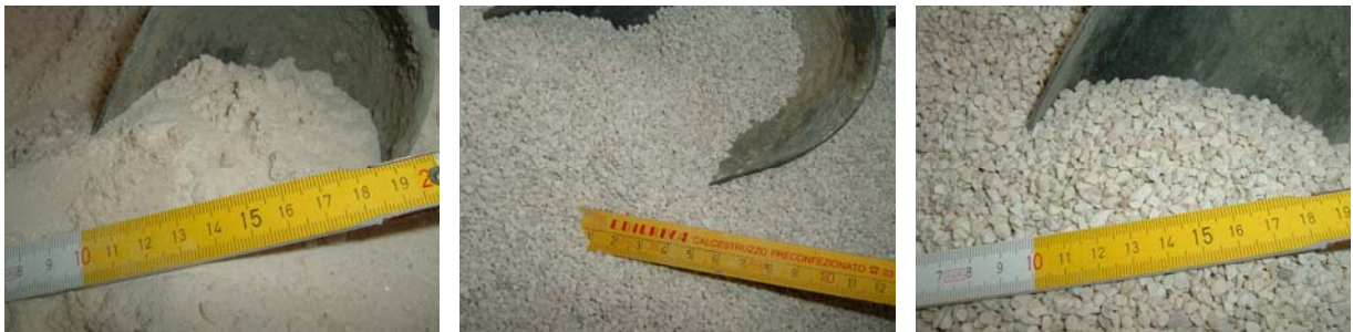
(a) (b) (c) Figura 3.4 - Frazioni granulometriche dell'aggregato calcareo: Polv , a), Calc1 b) e Calc2 c).
