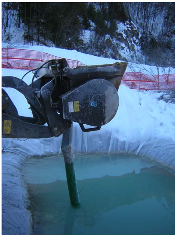
Figura 8.4 - Prova di riempimento di una trincea riempita con acqua solfatica a) impiegando la prima miscela confezionata in cantiere b) .
