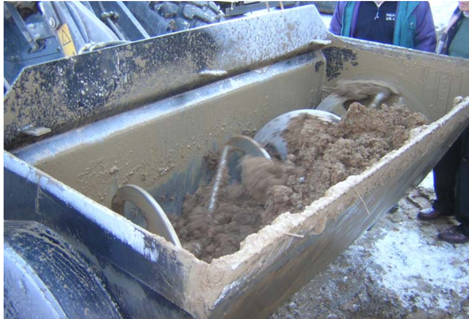
Figura 8.3 – Miscelazione mediante coclea posizionata all'interno della benna.
