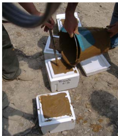
Figura 8.12 - Confezionamento di provini cubici con la miscela cementizia M4.
