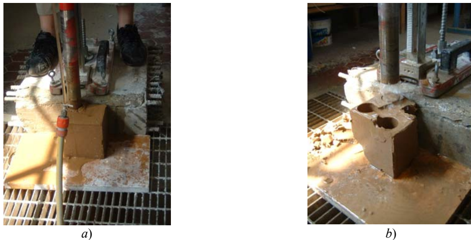
Figura 8.14 - Carotaggio di un provino cubico a) da cui sono state ricavate carote da sottoporre a prova di compressione b) .
