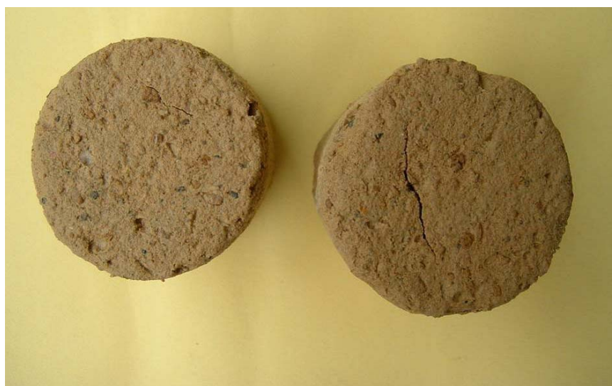
Figura 5.15 – Particolare delle fessure della carota M97-6 immersa in acqua solfatica per 28 giorni.
