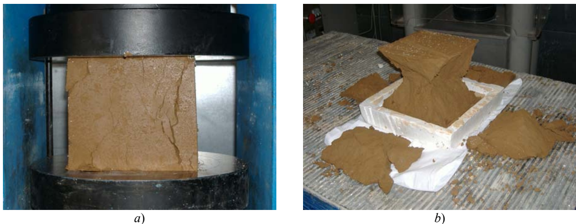
Figura 8.13 - Provino cubico sottoposto alla prova di resistenza a compressione a) sino a rottura b) .
