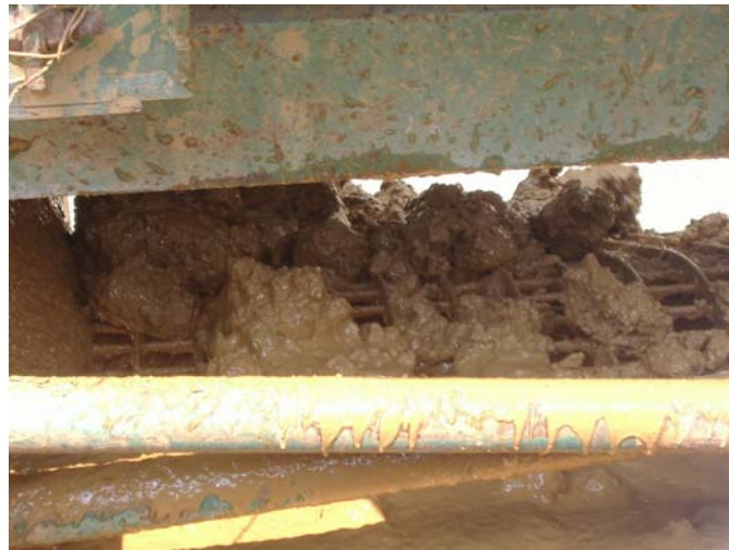
Figura 8.8 – Agglomerati grossolani di materiale trattenuti in prossimità della griglia di vagliatura posta prima della camera di aggiunta del cemento.
