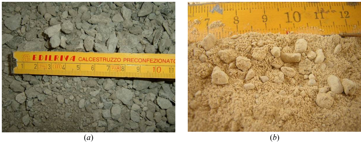
Figura 3.1 - Campione tal quale di pozzolana (a) e del terreno sciolto ( Arg1 ) proveniente da Santa Brigida (b).
