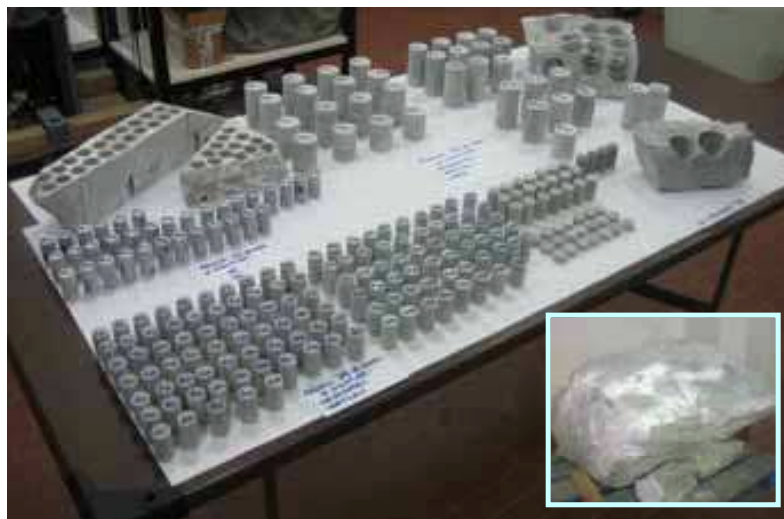
Fig. 12: Provini di anidrite intatta ricavati dal blocco mostrato per l'intera campagna. Fig. 12: Intact anhydrite specimen for all the experimental tests on anhydrite.
