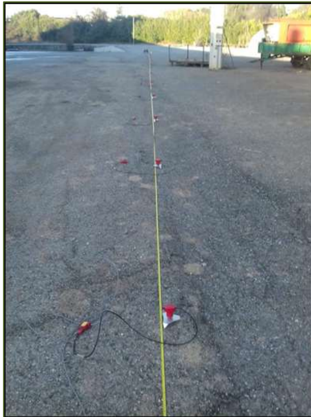
Figura 14 – Esecuzione dell'indagine MASW
